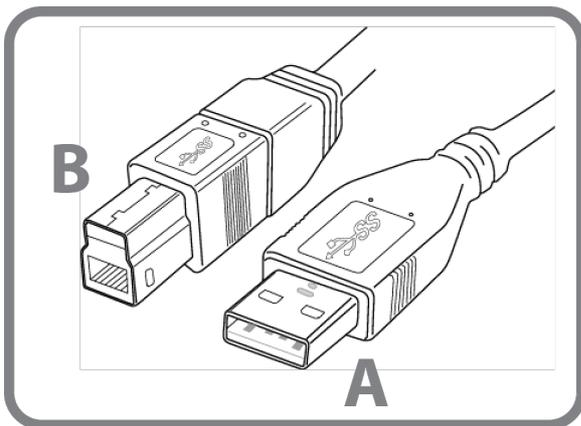
**Anschluss A:** Anschluss an den USB-Anschluss an Ihrem PC
